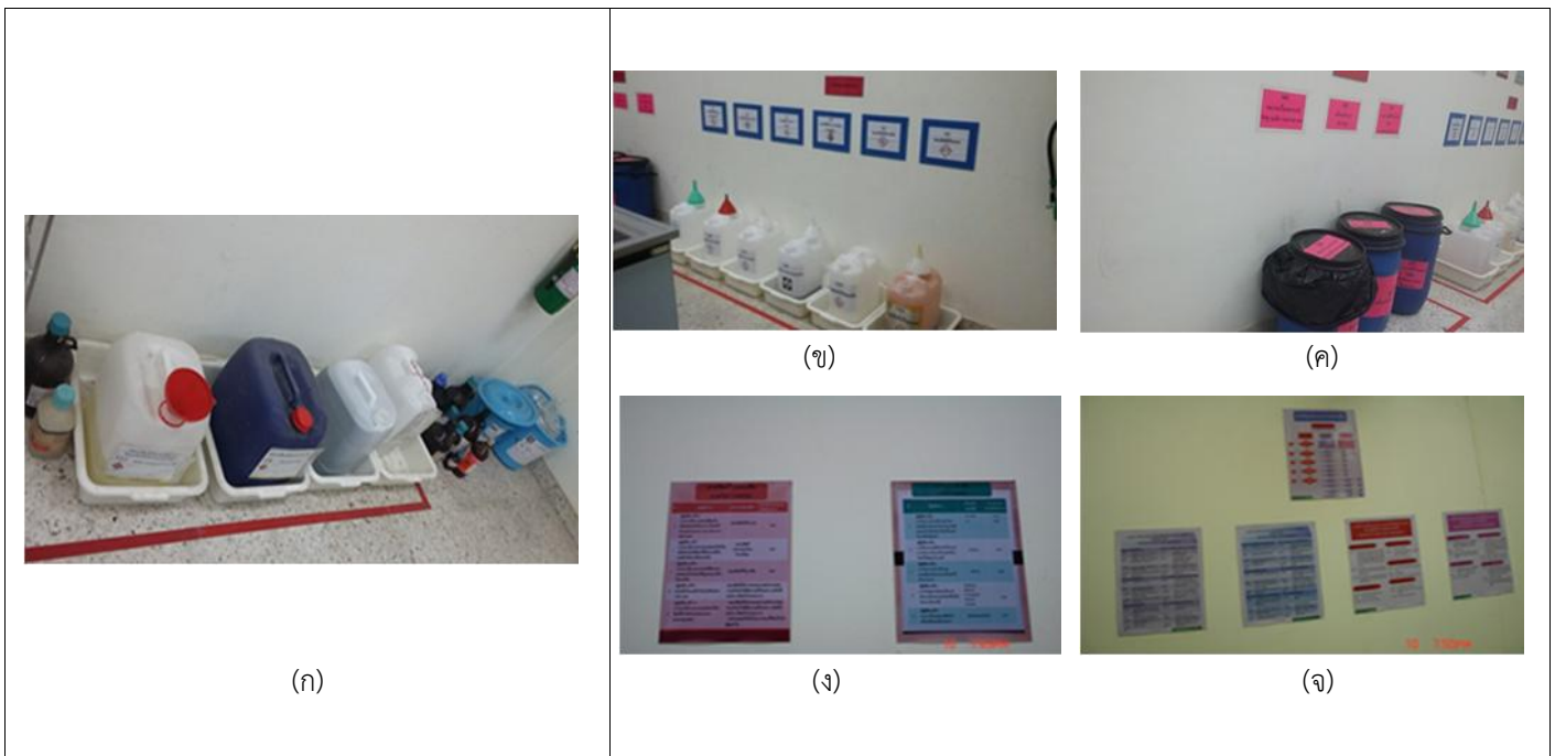
ภาพที่ 3 การจัดเก็บของเสียก่อนและหลังการพัฒนา ด้านที่ 3 (ก) การจัดเก็บของเสียที่มีหลากหลายภาษา (ข) การจัดเก็บของเสียชนิดของเหลว (ค) การจัดเก็บของเสียชนิดของแข็ง (ง) ป้ายการจัดเก็บของเสียรายวิชา 256353, 256252 (จ) ป้ายสัญลักษณ์อันตรายและป้ายการจัดเก็บของเสียอันตรายทั้งของเหลวและของแข็ง
