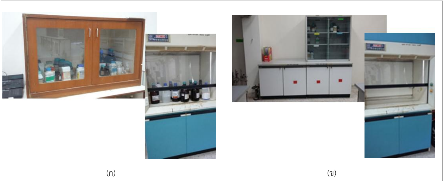
ภาพที่ 2 การจัดเก็บสารเคมีก่อนและหลังการพัฒนา ด้านที่ 2 (ก) การจัดเก็บสารเคมีที่ไม่ได้แยกสถานะในตู้ไม้ที่ไม่แข็งแรง และการเก็บสารเคมีประจำในตู้ดูดควัน (ข) การจัดเก็บสารเคมีที่แยกประเภทตามสถานะและตู้ดูดควันที่เหมาะสมต่อการใช้งาน
