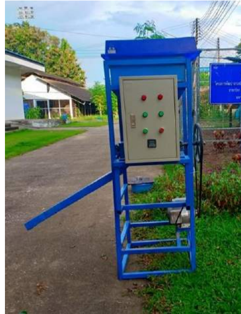
ภาพที่ 2 เครื่องให้อาหารไก่อัตโนมัติโดยใช้ชุดโปรแกรมคอนโทรลเลอร์
