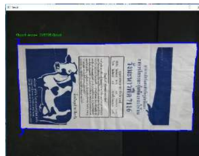
ภาพที่ 4 ตัวอย่างภาพ Binary และผลการทดลองการหาพื้นที่ของกระสอบ 30 kg
