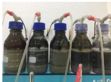
ภาพที่ 1 การผลิตแก๊สมีเทนจากเศษอาหารโดยใช้เหล็กวาเลนซ์ศูนย์เป็นบัพเฟอร์ในขวดหมักขนาด 500 มิลลิลิตร
