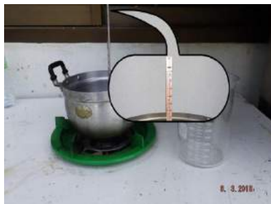
ภาพที่ 12 แสดงภาพการทดลองต้มน้ำ 1,000 มิลลิลิตร เพื่อหาจุดเดือดที่ 98 องศาเซลเซียส
