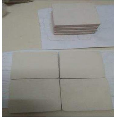
ภาพที่ 3 ผลิตภัณฑ์ทนไฟที่เตรียมได้จากสูตรที่ 8
