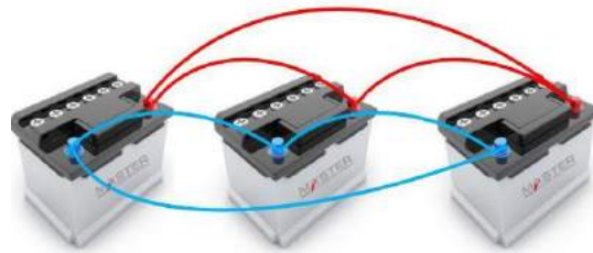
ภาพที่ 1 ลักษณะการต่อแบตเตอรี่แบบคอสลิงส์
