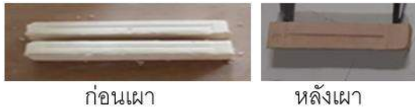
ภาพที่ 2 ตัวอย่างแท่งทดลองหลังทำการขึ้นรูปแล้วทั้งก่อนเผาและหลังเผาที่อุณหภูมิ 1300^{\circ}\text{C}
