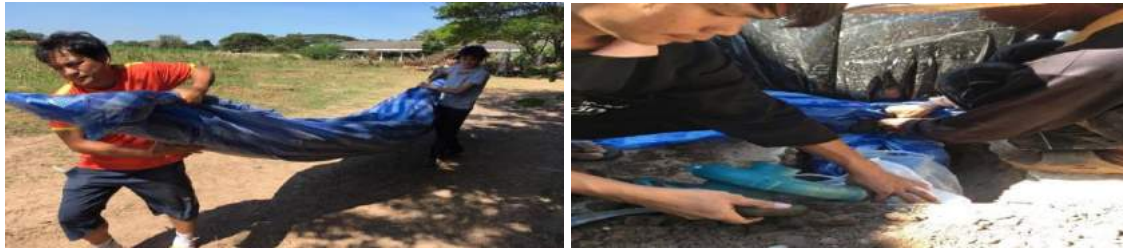
ภาพที่ 6 ย้ายถุงก๊าซที่ประกอบท่อทางเข้าและท่อทางออก และแสดงภาพการเติมลมทดสอบการพองของถุงก๊าซ
