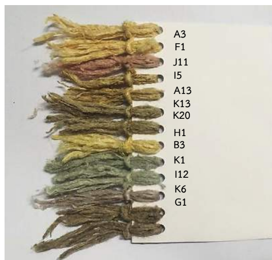
ภาพที่ 3 แอคติโนแบคทีเรีย 13 ไอโซเลต ที่ย้อมติดเส้นใยไหมโดยให้สีเข้มที่สุดในแต่ละกลุ่มชนิดสี
