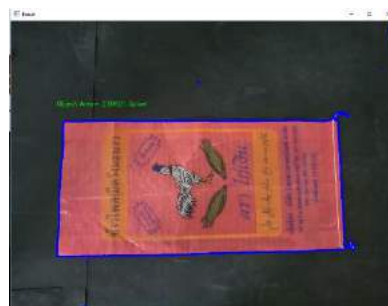
ภาพที่ 3 ตัวอย่างภาพ Binary และผลการทดลองการหาพื้นที่ของกระสอบ 10 kg
