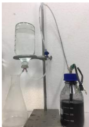
ภาพที่ 2 การวัดปริมาตรแก๊สมีเทนด้วยวิธีการแทนที่ของเหลว
