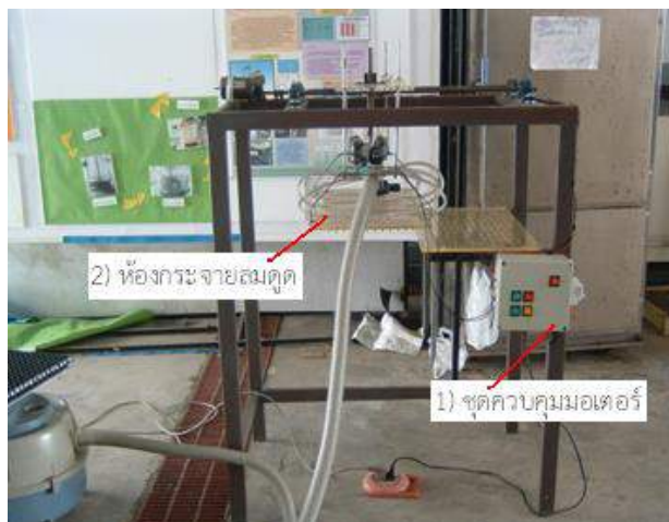
ภาพที่ 3 อุปกรณ์ย้ายเมล็ดลงถาดเพาะกล้าแบบใช้ลมดูด
