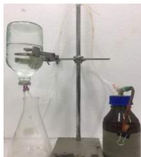
ภาพที่ 2 การวัดปริมาตรแก๊สมีเทนด้วยวิธีการแทนที่ของเหลว
