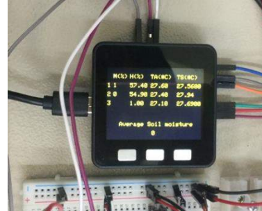
ภาพที่ 1 ผลการทดสอบระบบ (ด้านซ้ายคือการสื่อสารจากระยะไกล ด้านขวามือแสดงผลที่อุปกรณ์ไมโครคอนโทรลเลอร์ M5Stack )
