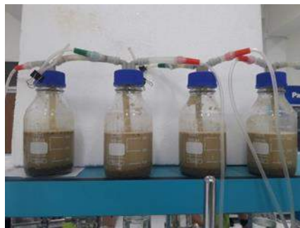
ภาพที่ 1 การผลิตแก๊สมีเทนจากเศษอาหารโดยใช้ชนิดและความเข้มข้นของบัฟเฟอร์ที่แตกต่างกัน
