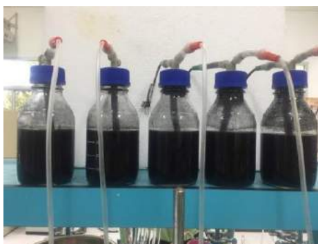
ภาพที่ 1 การผลิตแก๊สมีเทนจากเศษอาหารโดยใช้ถ่านกัมมันต์เป็นบัฟเฟอร์ในขวดหมักขนาด 500 มิลลิลิตร
