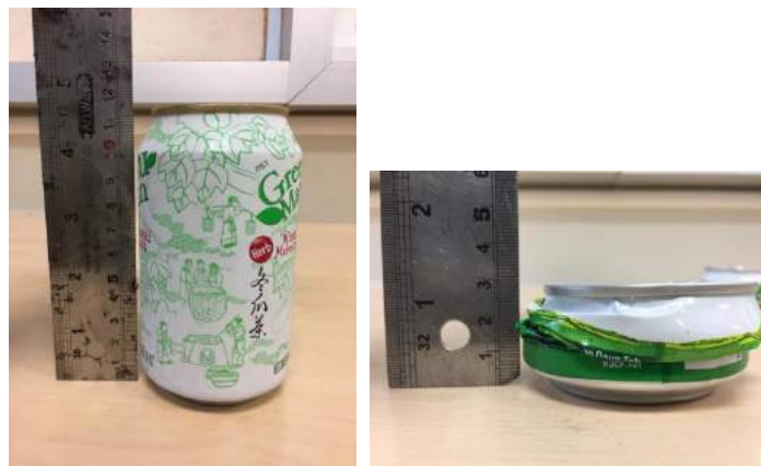
ภาพที่ 7 ขนาดกระป๋องอลูมิเนียมและเมื่อทำการบีบอัดจากเครื่องบีบอัดกระป๋องอลูมิเนียมอัตโนมัติ
